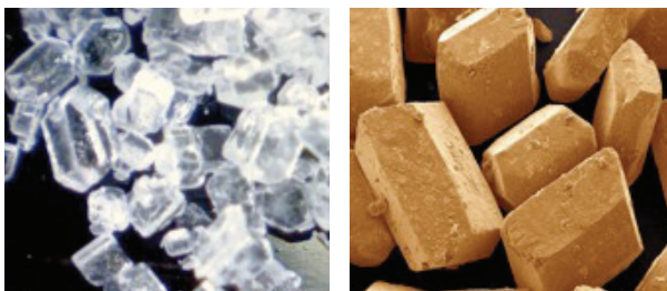
Fig. 1 – (esquerda) Cristais de sacarose numa ampliação de 100x; (direita) Micrografia eletrónica de cristais de sacarose
